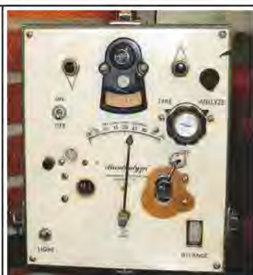
Breathalyzer-instrumentet som utvecklades av Robert Borkenstein (Indiana, USA) under mitten av 1950-talet.
